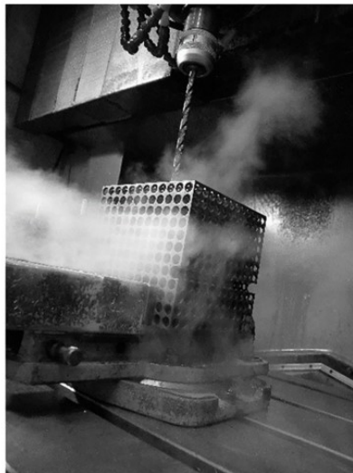
Figura 1. Refrigeración criogénica desarrollada por UPV/EHU y Tecnalía.
