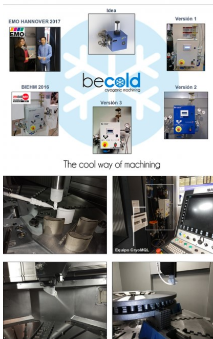
Figura 3. Proceso de desarrollo de equipo CryoMQL Plug & Play y aplicación a casos reales.
